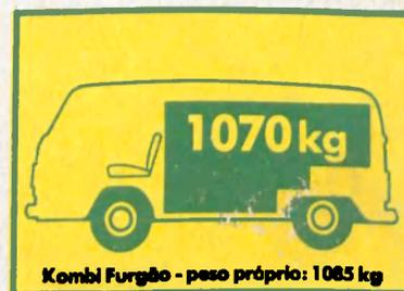
Os detalhes de construção de todas as versões da Linha Kombi, especialmente a posição da cabina, permitem maior aproveitamento do compartimento de carga, possibilitando uma distribuição homogênea do peso sobre os eixos. Nenhum outro veículo da sua categoria transporta 1 tonelada de carga útil.
