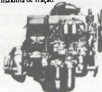
O motor OM-352/A, com seis cilindros em linha, injeção direta e avanço automático de injeção, conjuga as vantagens do rendimento termodinâmico com as do sistema de turboalimentação.
