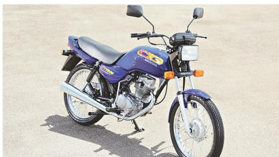
// 3ª geração da CG: adoção da ignição elétrica no lugar do platinado
