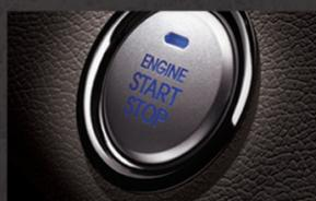
SISTEMA DE IGNIÇÃO KEYLESS COM SENSOR DE PROXIMIDADE E BOTÃO START/STOP.
