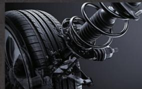
SUSPENSÃO COM AMORTECEDORES DE REGULAGEM AUTOMÁTICA.
